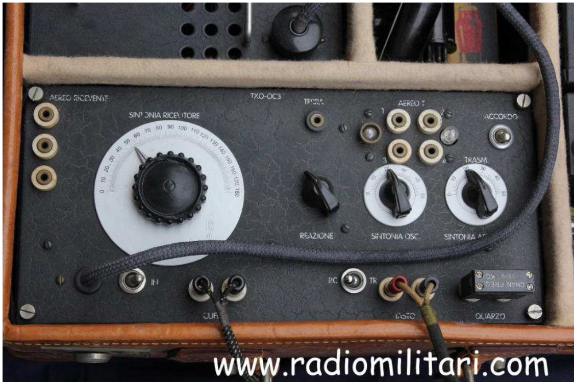
Particolare del TX0- OC3 in evidenza la sintonia del ricevitore ed i vari ingressi di collegamento
