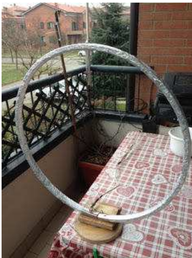
antenna ricoperta con un foglio di domopack alluminio
